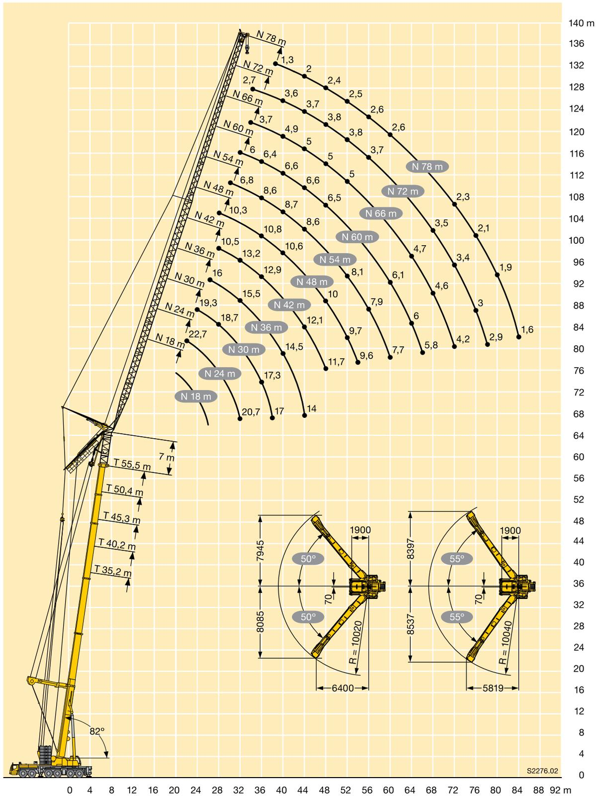
Winkel der Y-Abspannung zwischen 50° bis 55°, abhängig vom Ausfahrzustand der einzelnen Teleskopteile.
